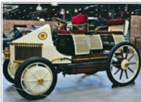
Электрический автомобиль Ф. Порше с электродвигателями в каждом колесе, выпущенный в 1900 г.
