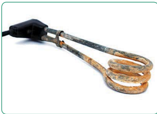
Рис. 79. Накипь на нагревательном элементе кипятыльника
