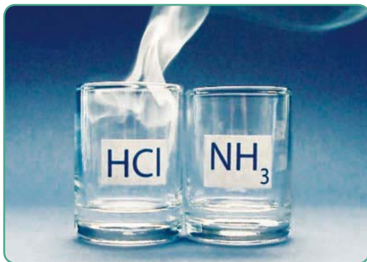
Рис. 19. Опыт «дым без огня». Пары хлороводорода и аммиака, взаимодействуя, образуют кристаллики хлорида аммония, похожие на дым
