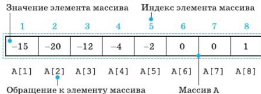
Рис. 1.9. Одномерный массив A из восьми элементов
