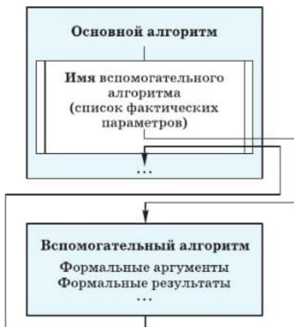
Рис. 1.5. Схема выполнения команды вызова вспомогательного алгоритма
