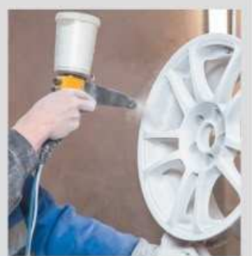
Равномерное окрашивание изделия наэлектризованной краской
