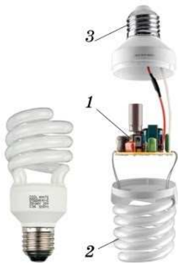
Рис. 112. Энергосберегающая лампа: 1 — пускорегулирующее устройство; 2 — стеклянная колба, покрытая люминофором; 3 — цоколь
