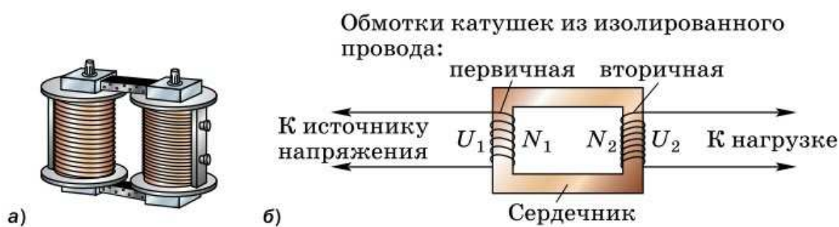
Рис. 176. Повышающий трансформатор: а — внешний вид; б — схема устройства
